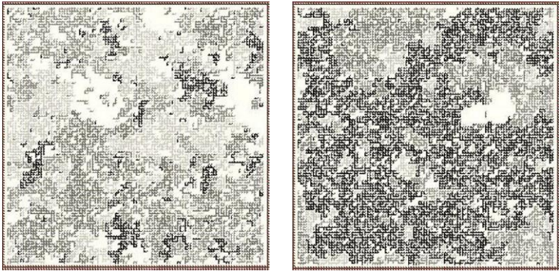
Рисунок 20 – Перколяційна мережа великого розміру. Зліва, випадок, коли концентрація зв'язків менша за пороговий, справа – більше
