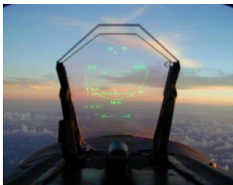
Рисунок 1 – Современный ИЛС, установленный на истребителе F/A-18
