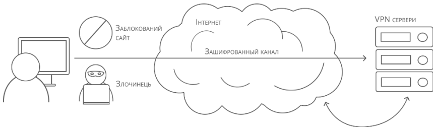
Рисунок 1 – Схема принципу роботи мережі VPN
