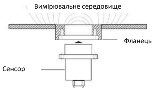
Рисунок 1 – Принцип дії вологоміра M-Sens 2
