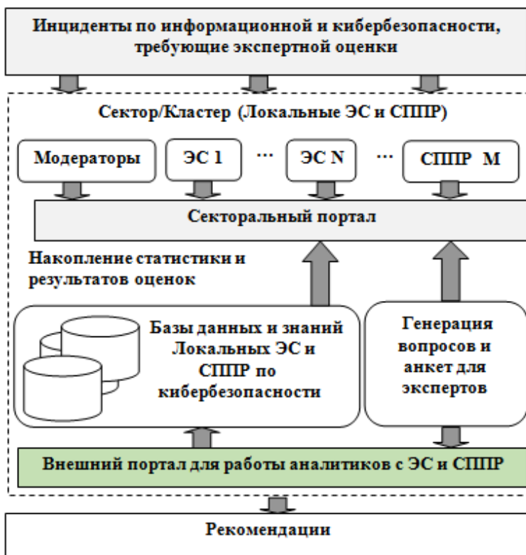
Рис. 1. Структурная схема секторальной (кластерной) платформы для объединения локальных СППР и ЭС по кибербезопасности
