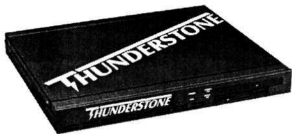
Рис. 2.26. Одноюнитовый сервер ThunderStone Search Appliance
